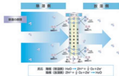
●固体高分子電解質膜を利用し、容器内の湿気を電気分解して除去する全く新しいタイプの除湿器です。
